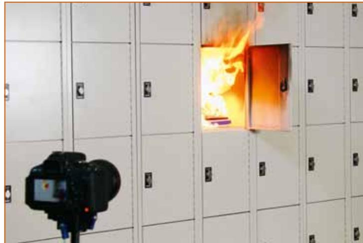
Abb. 3: Das Versuchsfach beim Entzünden der Brandlasten
