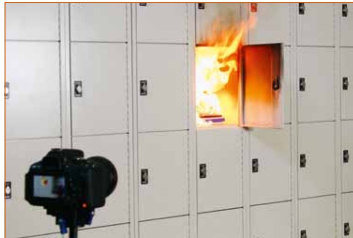
Abb. 3: Das Versuchsfach beim Entzünden der Brandlasten
